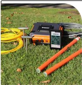
El Stratagem EH-5 un Sistema AMT / Audio Magnetotelúrica de alta frecuencia y última generación que se utiliza para medir la impedancia eléctrica en la superficie de la tierra mediante una serie de mediciones simultáneas de las fluctuaciones del campo magnético y eléctrico local.
