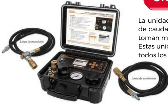
La unidad de control de la bomba permite velocidades de purgado más rápidas y un control de caudal preciso para asegurar una muestra representativa a 100 ml/min o menos cuando se toman muestras de COV (compuestos orgánicos volátiles).
